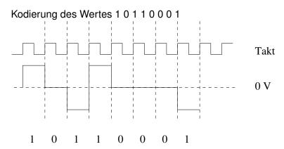
► Keine automatische Taktrückgewinnung, gleichspannungsfrei
