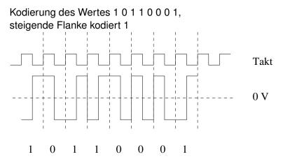
Automatische Taktrückgewinnung, gleichspannungsfrei
