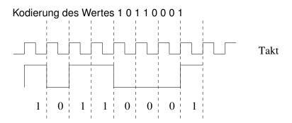
► Keine automatische Taktrückgewinnung, nicht gleichspannungsfrei
