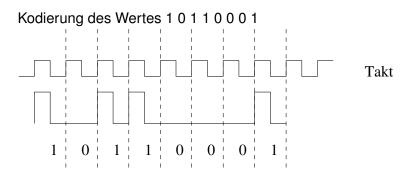
► Keine automatische Taktrückgewinnung, nicht gleichspannungsfrei
