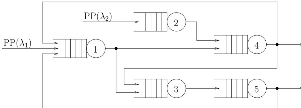
Die Stationen 1 bis 3 seien jeweils  $M/M/1/\infty$ -Systeme mit Bedienraten  $\mu_1 = 8$ ,  $\mu_2 = 3$ ,  $\mu_3 = 5$ , die Station 4 sei ein  $M/M/\infty$ -System mit Bedienrate  $\mu_4 = 1$  und die Station 5 sei ein  $M/M/2/\infty$ -System mit Bedienrate  $\mu_5 = 5$ .
