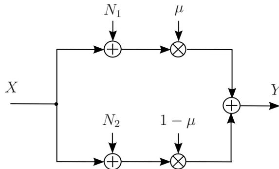
Das Eingangssignal  $X$  unterliege der Leistungsbeschränkung  $E(X^2) \leq 4$  und habe den Erwartungswert  $E(X) = 0$ . Die additiven Rauschterme  $N_1$  und  $N_2$  seien normalverteilt mit  $N_1 \sim N(0, 1)$  und  $N_2 \sim N(0, 2)$ . Das Eingangssignal  $X$  und die beiden Rauschterme  $N_1$  und  $N_2$  seien gemeinsam stochastisch unabhängig. Für den Parameter  $\mu$  gelte  $0 \leq \mu \leq 1$ . Die Zufallsvariable  $Y$  repräsentiere das Ausgangssignal.
